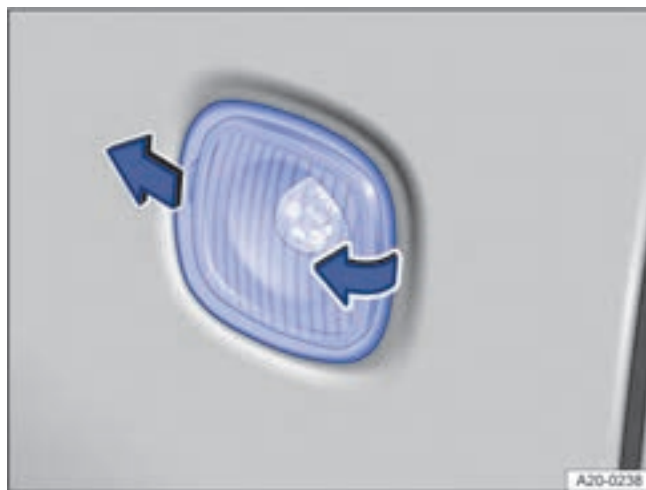
Фиг. 163 На страната на автомобила: демонтиране на страничния мигач.
