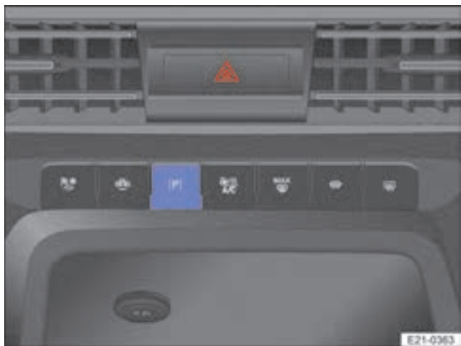
Фиг. 115 В средната конзола: контролен панел за функции за паркиране.
