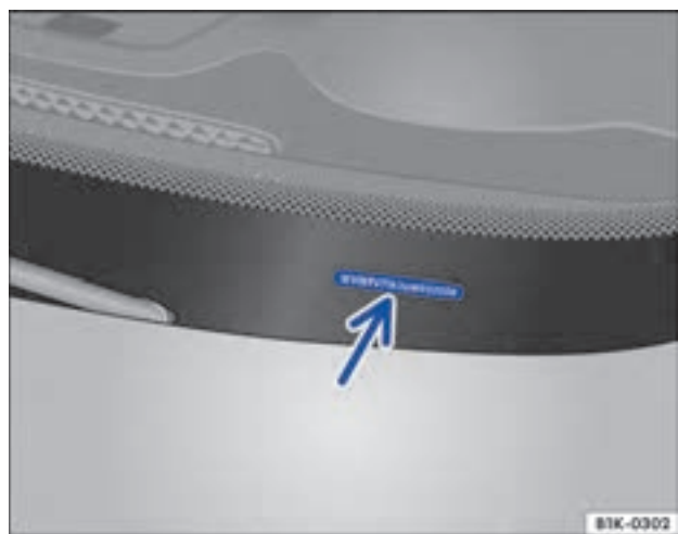
Фиг. 212 На предното стъкло: идентификационен номер на автомобила.
