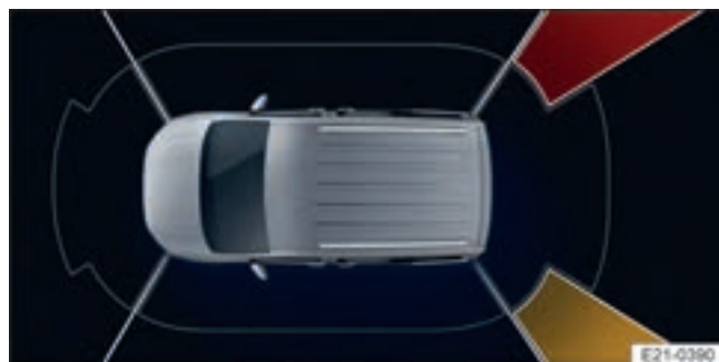
Фиг. 128 На екрана на системата Инфотейнмънт: индикация на системата за предупреждение за напречен трафик.
