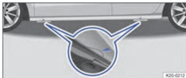
Фиг. 204 Места за повдигане с крика.
