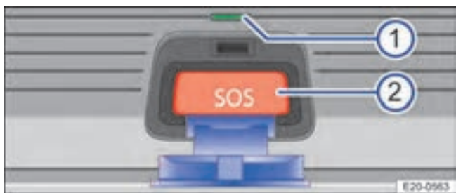
Фиг. 44 Бутон за обслужване за спешно повикване: контролен индикатор и бутон.
