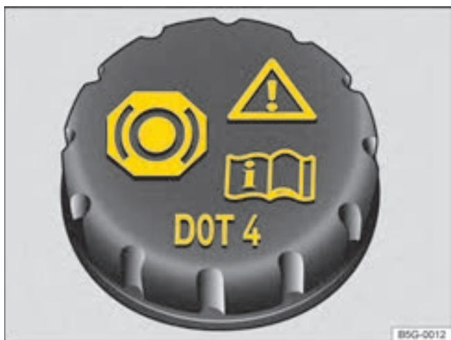
Фиг. 190 В околomotorното пространство: капачка на казанчето за спиращата течност.
