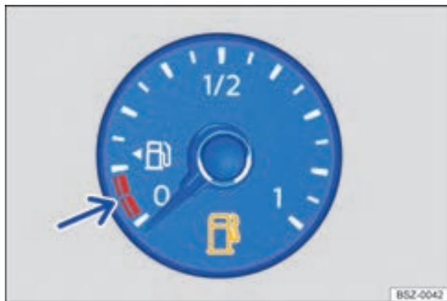
Фиг. 12 Индикатор на запаса от гориво на аналоговото арматурно табло (принципно изображение).
