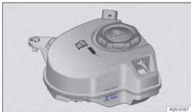
Фиг. 189 В моторния кош: Маркировка на казанчето за охлаждащата течност (принципно изображение).
