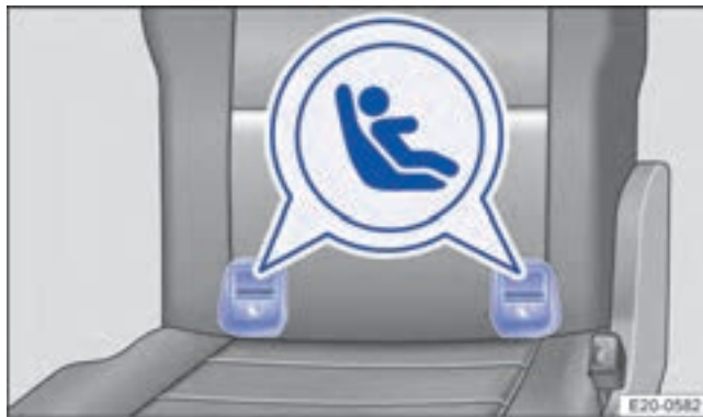
Фиг. 36 На седалката на автомобила на трети ред седалки: Варианти на обозначаване на ISOFIX-точките за закрепване на детски седалки.
