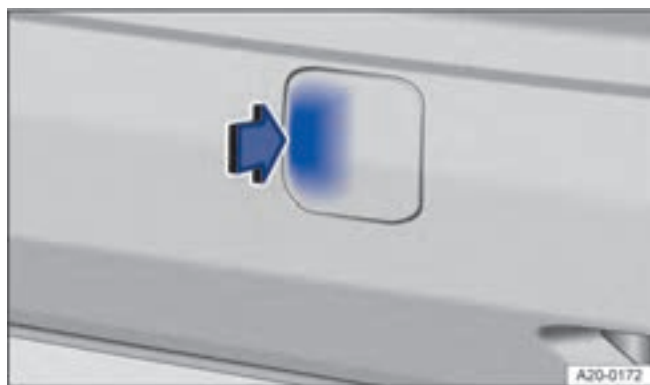
Фиг. 174 В задната дясна част на бронята: сваляне на капака.
