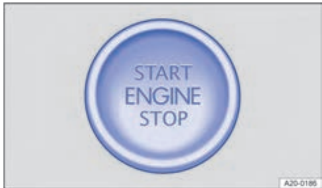
Фиг. 95 В долната част на средната конзола: бутон за стартиране, служещ за стартиране на двигателя.
