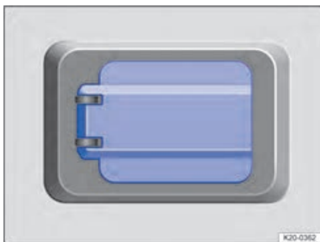
Фиг. 133 На задната средна конзола или на разделителната стена към товарното отделение: сгъваем 230-волтов заземен контакт (принципно изображение).
