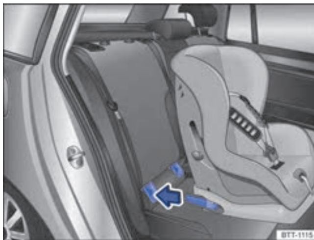
Фиг. 37 Принципно изображение: Монтиране на детска седалка ISOFIX с фиксиращи рамена.
