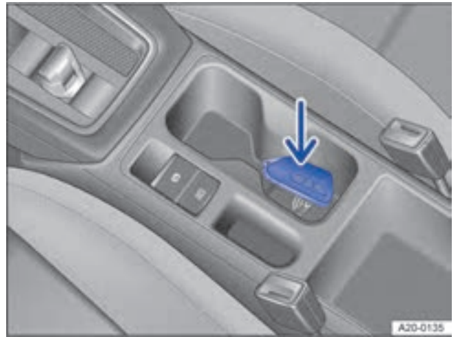
Фиг. 96 В средната конзола: функция за аварийно стартиране.
