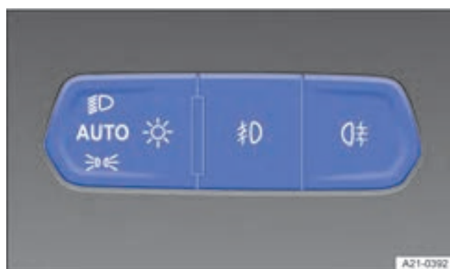
Фиг. 76 До волана: панел за управление за включване на външните светлини.
