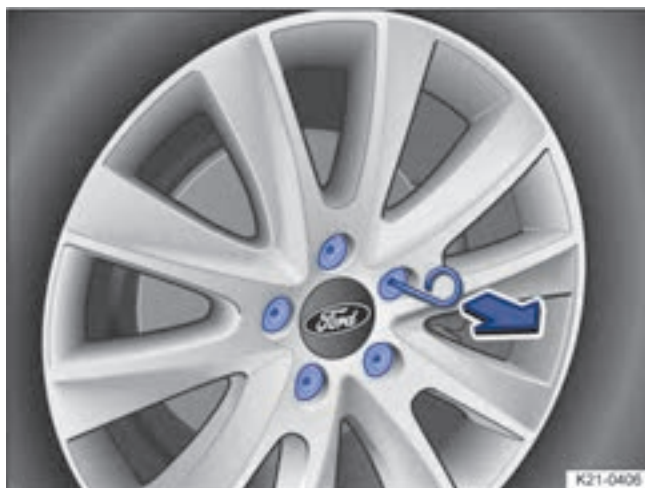
Фиг. 201 Сваляне на капачките на болтовете.
