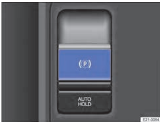
Фиг. 112 В средната конзола: бутон за паркинг спирачката.
