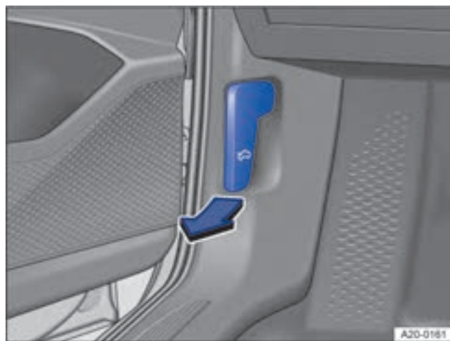
Фиг. 178 В пространството за краката вляво: лост за деблокиране на предния капак (принципно изображение).
