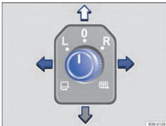
Фиг. 85 Във вратата на водача: бутон за външните огледала.
