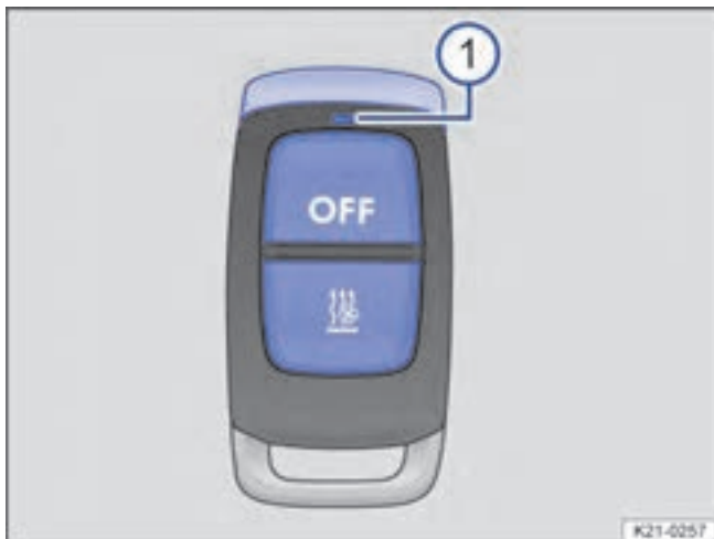
Фиг. 88 Дистанционно управление за стационарното отопление.
