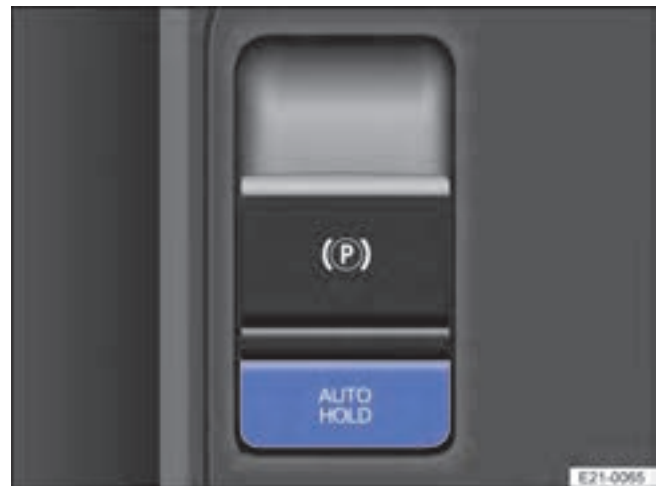
Фиг. 113 В средната конзола: Бутон за Auto Hold.
