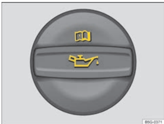
Фиг. 187 В моторния отсек: капачката на отвора за наливане на моторно масло (принципно изображение).
