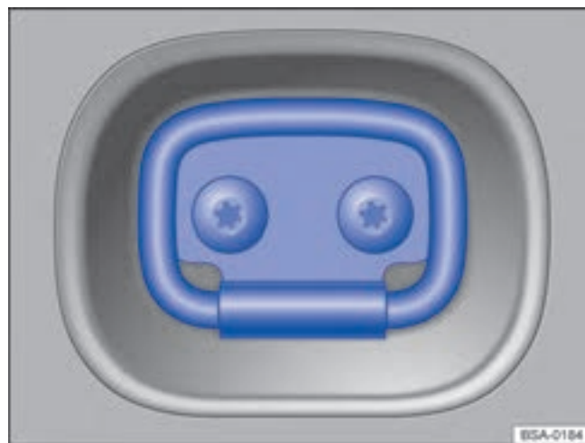
Фиг. 144 В товарната област: Закрепващи халки.
