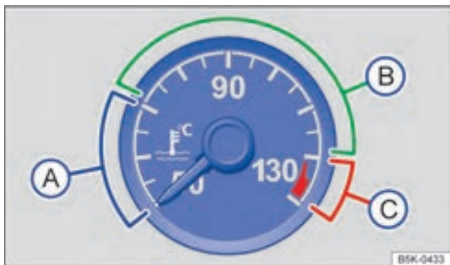
Фиг. 13 Температурен индикатор за охлаждащата течност на двигателя на аналоговото арматурно табло (принципно изображение).
