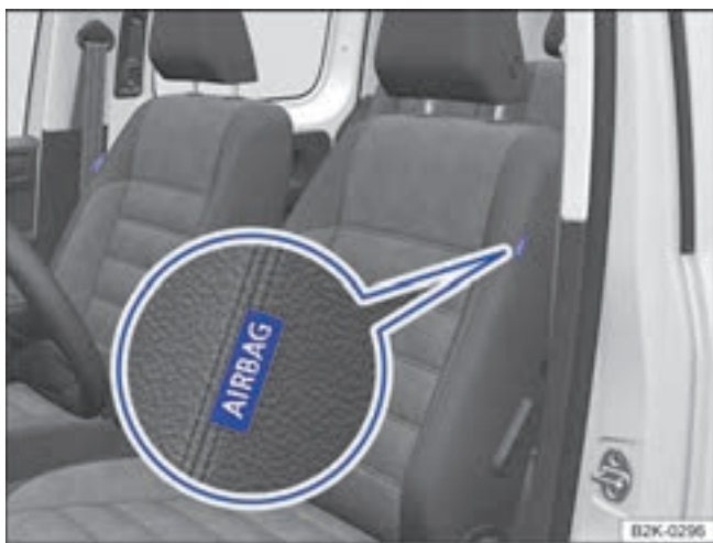
Фиг. 30 Странично в предната седалка: място за монтаж на страничната въздушна възглавница.
