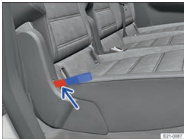
Фиг. 60 Втори ред седалки: маркировка за несигурно застопорена облегалка на седалка.
