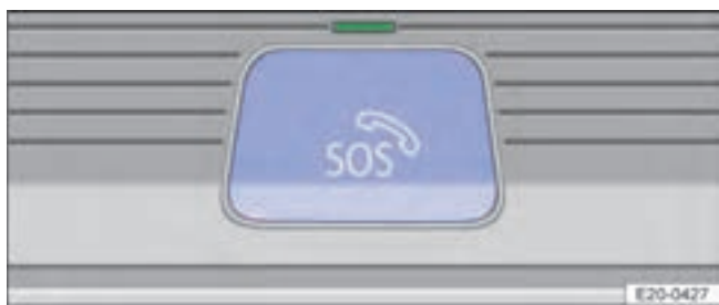
Фиг. 43 В конзолата на тавана: бутон за обслужване на системата за спешни повиквания eCall (зад капака на бутона).
