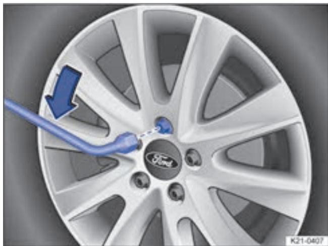
Фиг. 207 Смяна на колела: Развийте болтовете за джантите с ключа за колела.
