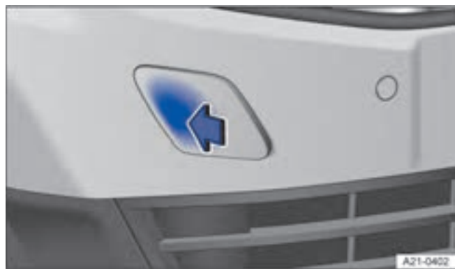
Фиг. 176 В бронята отпред вдясно: сваляне на капака.
