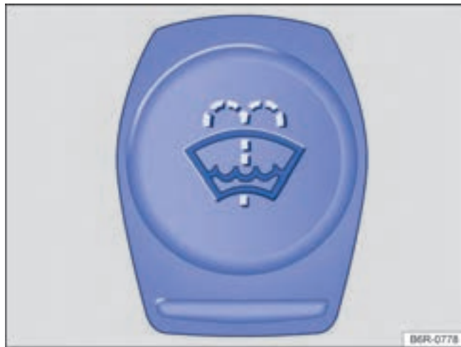
Фиг. 183 В околomotorното пространство: капачка на казанчето за течността за чистачките.
