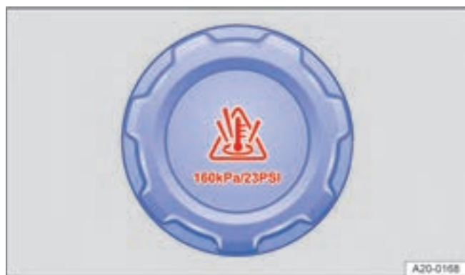
Фиг. 188 В околomotorното пространство: капачка на резервоара за охлаждащата течност.
