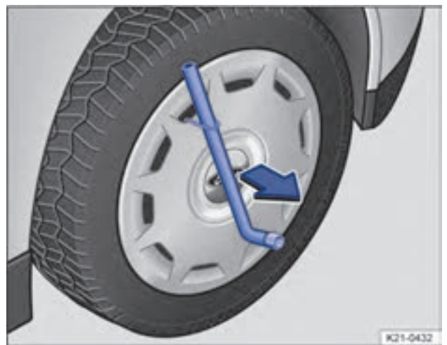
Фиг. 200 Сваляне на широк тас.
