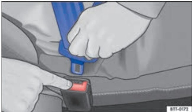
Фиг. 20 Освободете заключващото езиче от ключалката на предпазния колан.
