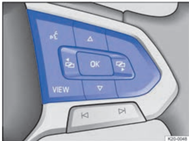
Фиг. 10 Дясна страна на многофункционалния волан: бутони за обслужване на менютата и информационните индикации на арматурното табло.
